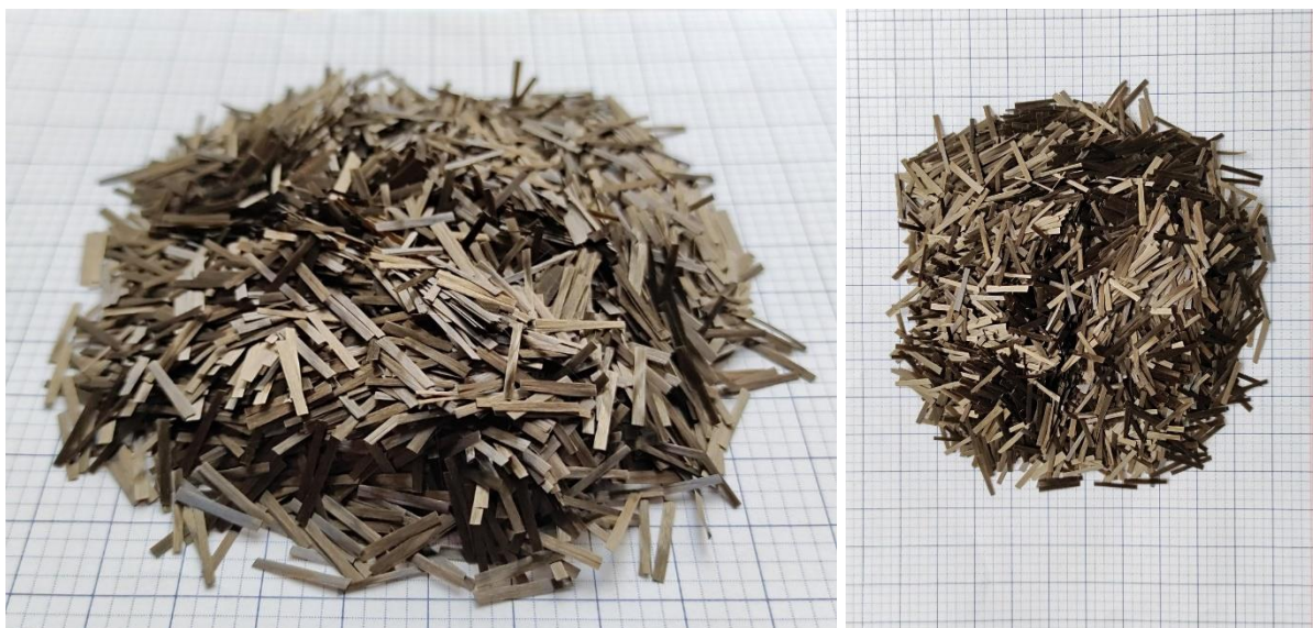
Hình 2.1. Sợi bazan được sử dụng trong nghiên cứu
