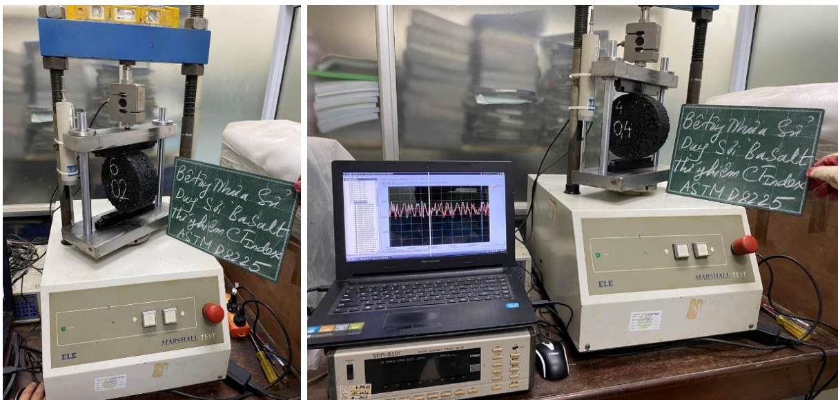
Hình 3.12. Quá trình thí nghiệm xác định chỉ số kháng nứt CT_{Index}
