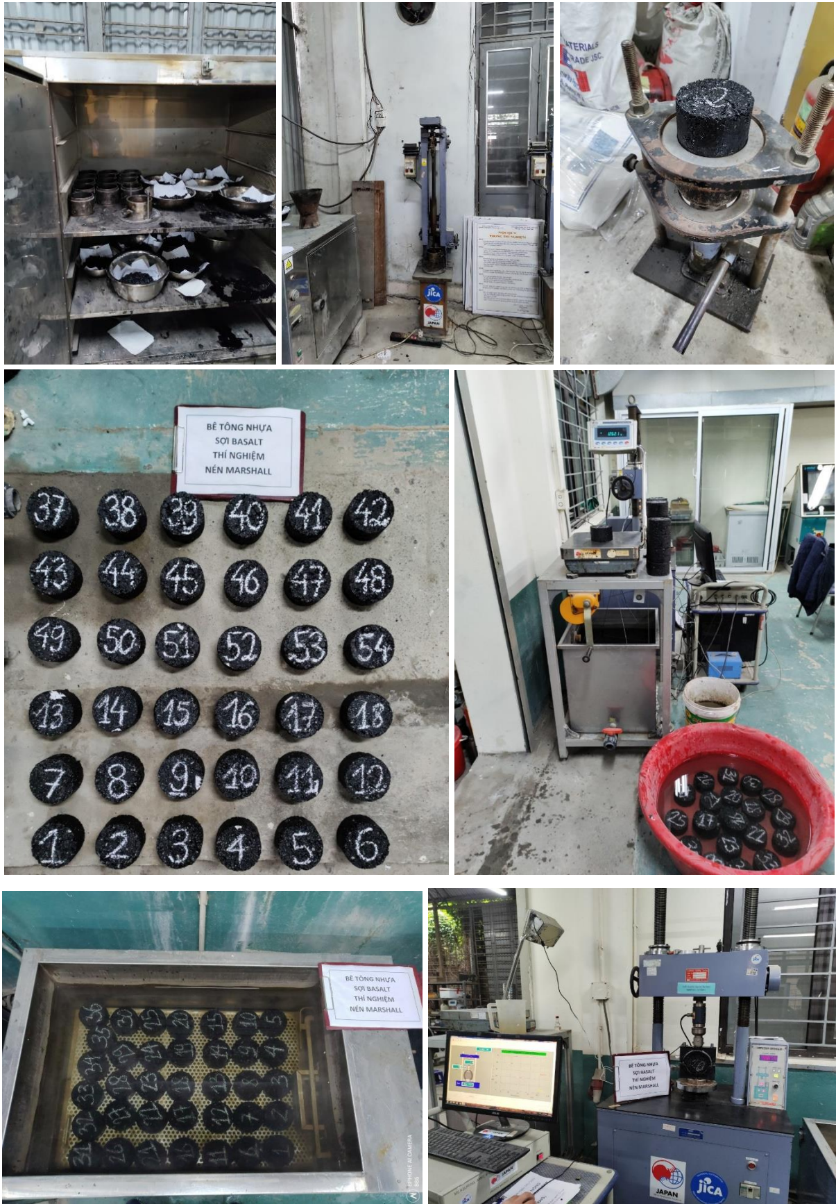
Hình 2.3. Quá trình đúc mẫu và thí nghiệm Marshall
