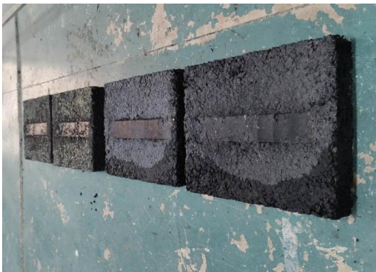
Hình 3.3. Mẫu BTN sau quá trình chạy LVBX
