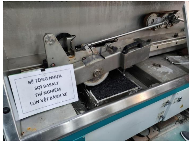
Chạy mẫu trên thiết bị wheel - tracking
