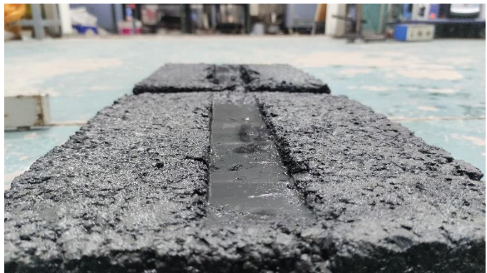
Hình 3.3. Mẫu BTN sau quá trình chạy LVBX
