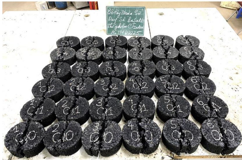
Hình 3.11. Mẫu thí nghiệm sau khi phá hoại
